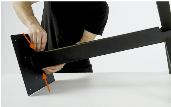
Steg 3: För in bulten genom båda rören. Fäst den lilla delen av bulten på mot stående sida och dra åt båda ändarna med insexnycklar.
