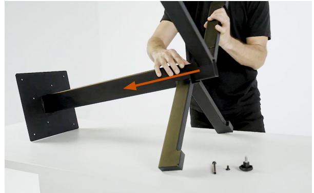
Steg 2: För in innerröret i ytterröret och rikta in bulthålen.
